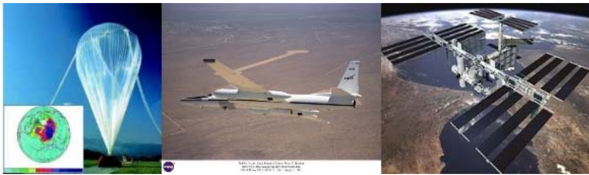
Abb. 3: Beispiele für Messplattformen für Feldmessungen in der Atmosphäre (von links nach rechts: Stratosphären-Ballon, hochfliegendes Flugzeug, Satellit zur Beobachtung der Umwelt vom Weltraum).
