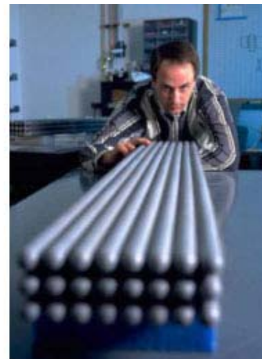
Röhrenförmige keramische Brennstoffzellen für ein Blockheizkraftwerk
