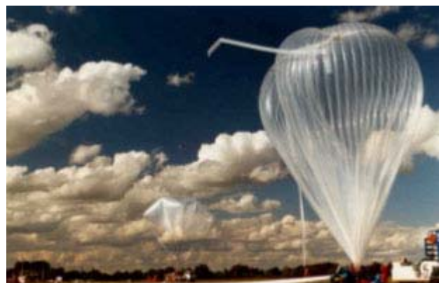
Vorbereitungen für den Start des ballongestützten In-situ-Laserspektrometers für den simultanen Nachweis von Wasser und Methan in der Stratosphäre (bis 35km).
