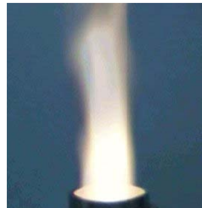
Fackel eines Plasmarektors. Ein solcher Reaktor eignet sich besonders zur Herstellung metallischer und nichtoxidischer Partikel
