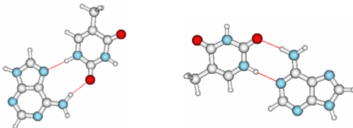
Abb. 4: Berechnete Strukturen des Adenin-Thymin-Clusters nach den experimentellen Ergebnissen
